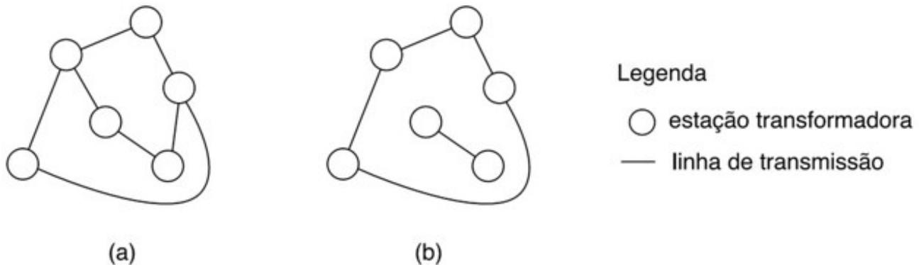
Os engenheiros de manutenção do sistema de transmissão de energia consideram que o sistema está em estado normal se há pelo menos uma rota entre qualquer par de estações, e em estado de falha caso contrário.
